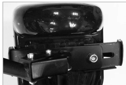
Svitare il dado della staffa del telaio principale (C) e regolarne la lunghezza in base alle dimensioni dell'hoverboard utilizzato.
