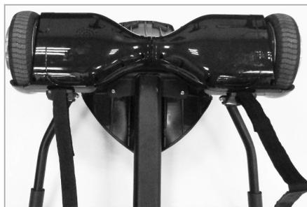
Inserire la cinghia di fissaggio (E) all'interno della feritoia anteriore della staffa del telaio principale (C) e fissarla su stessa con il velcro. Procedere allo stesso modo con la seconda cinghia di fissaggio (E). Appoggiare l'hoverboard in posizione capovolta.
