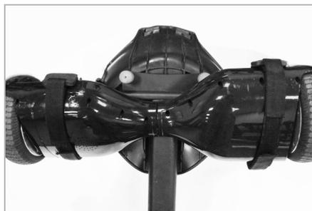
Far passare entrambe le cinghie di fissaggio (E) attorno alla superficie inferiore dell'hoverboard e infilarle nell'apposita feritoia posteriore della staffa del telaio principale (C). Stringere bene e richiuderle su loro stesse con il velcro.
