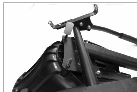
Poggiare la seduta (A) in corrispondenza dei 4 fori della piastra centrale del telaio principale (C). Inserire le 2 viti (I) nei 2 fori anteriori. Svitare le 2 viti dai cuscinetti ammortizzanti (H) e inserirle nei 2 fori posteriori. Serrare tutte le viti con la chiave a brugola (N)
