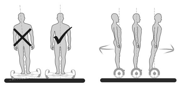
BEFORE TURNING, YOU HAVE TO REDUCE THE SPEED MOVING YOUR WEIGHT SLIGHTLY BACK-
