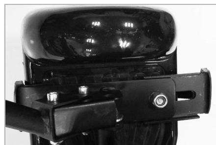
Dévisser l'écrou de l'étrier du châssis principal (C) et en régler la longueur selon les dimensions de l'hoverboard employé.
