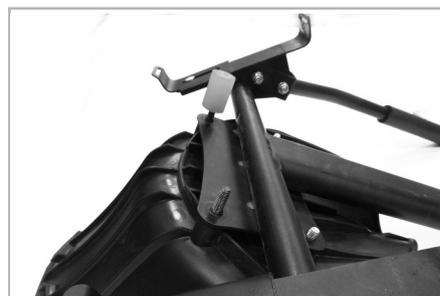
Appuyer le siège (A) en correspondance des 4 trous de la plaque centrale du châssis principal (C). Insérer les 2 vis (I) dans les 2 trous antérieurs. Dévisser les 2 vis des roulements amortisseurs (H) et les insérer dans les 2 trous postérieurs. Serrer toutes les vis en employant la clé Allen (N).
