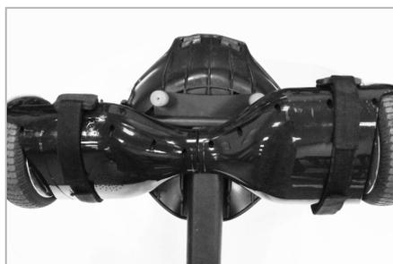
Toutes les deux sangles de fixation (E) autour de la surface inférieure de l'hoverboard et dans la fente postérieure de l'étrier du châssis principal (C). Serrer bien et les fermer sur leurs mêmes avec le velcro.
